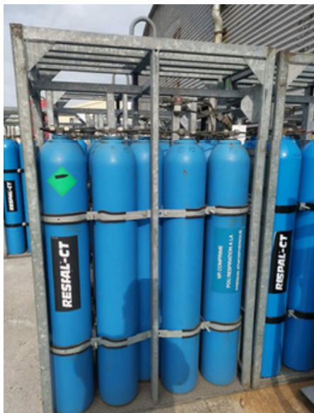
2*50L 200 bars (autonomie ≈ 7h) pour 1 porteur
